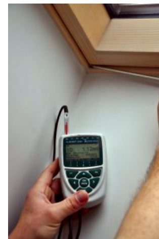
Lokalizacja nieszczelności z zastosowaniem termoanemometru
