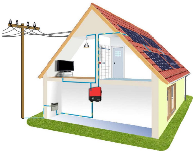
Instalacja podłączona do sieci (on grid)
