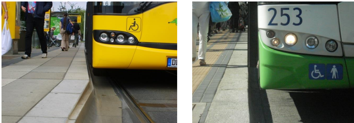
Rys. VII.3.1. Zalecane ukształtowanie krawędzi peronowej Źródło: materiały własne TRAKO)
