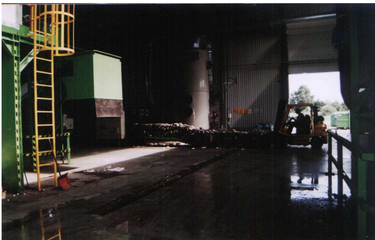
Fot.2. Odbiór sprasowanych odpadów (ZUOK w Puławach)
