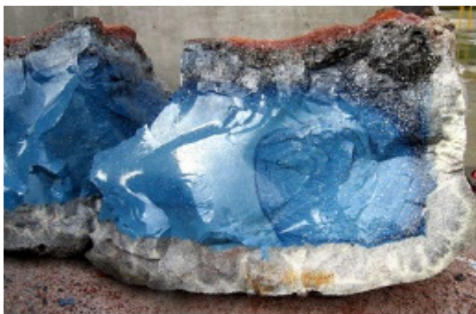
Rys. 17. Azbest po przetopieniu w reaktorze plazmowym [15]
