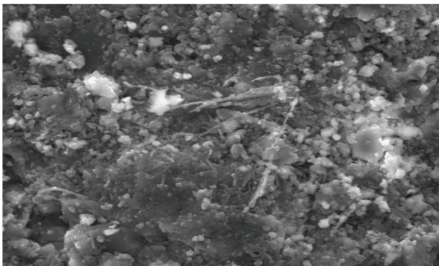
Rys. 2. Zmiany powierzchni płyty w wyniku korozji atmosferycznej.
