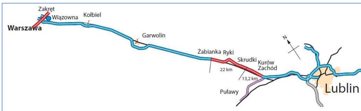
Rysunek 12. Przebieg projektowanej S17 - obejmujący budowę dwóch odcinków S17 od węzła Kurów Zachód do węzła Skrudki i dalej do granicy z województwem mazowieckim.
